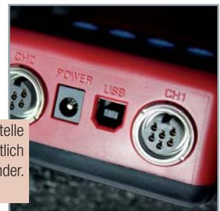
Sensoranschlüsse, USB-Schnittstelle und Netzteil-Buchse übersichtlich nebeneinander.
