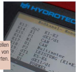
Berechnungen mit individuellen Formeln und Anzeigen von CAN- oder Multimeter-Messwerten.
