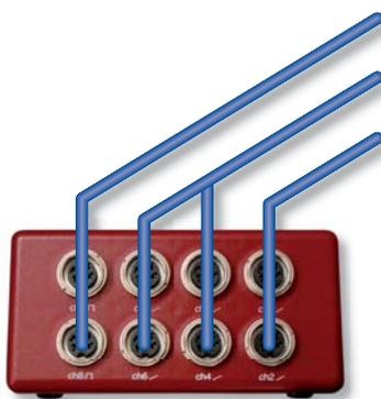
**Sensoren mit Frequenz-Ausgangssignal** (z.B. Volumenstrom, Drehzahl)
