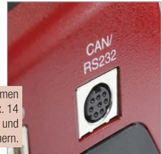
Signale aus CAN-Bussystemen (z.B. CANopen, J1939) auf max. 14 Kanälen anzeigen und speichern.
