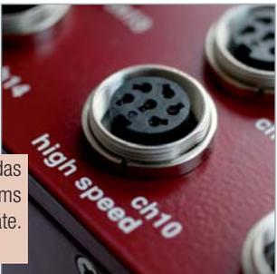
Zwei Highspeed-Eingänge für das Messen analoger Signale mit 0,1 ms Messrate.
